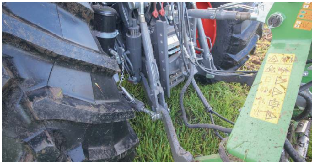
Tijdens een multi-trekkertest (zie uitgave 389 en 390) bleek het hefvermogen relatief gezien aan de lage kant. Dát paste Claas nu aan met dikkere hefcilinders (90 millimeter dik) en nu dubbel gebogen hefcilinders zodat vanghaken beter een categorie 3-werktuig kunnen oppikken.
