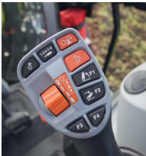
Met deze joystick kun je vijf ventielen bedienen: voorlader, fronthef of extern. Praktisch is ook de kopakker-versnelling, waarmee je snel terugschakelt.
